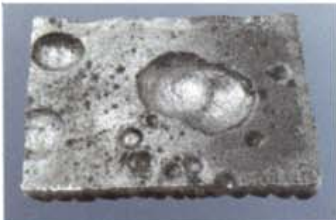
De stalen plaat laat de aantasting zien door bacteriologische corrosie, veroorzaakt door sulfaat etende bacteriën.
